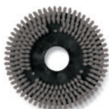
szczotka PPL nienasiąkliwa, wysoka odporność na ścieranie; średnica 508 mm; grubość włosa 0,3-0,9 mm
