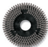
szczotka PPL nienasiąkliwa, wysoka odporność na ścieranie; średnica 345 mm; grubość włosa 0,6-0,9 mm
